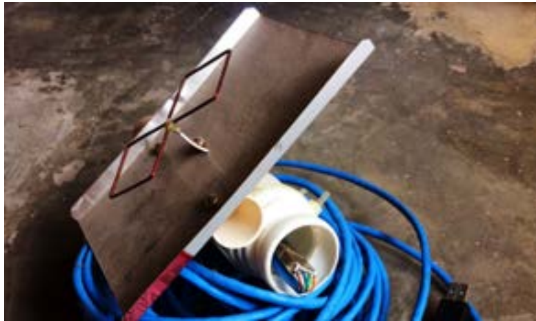
Rys. 7: Antena Wi-Fi „biquad” wykonana z Wi-Fi USB oraz materiałów pochodzących z recyklingu
